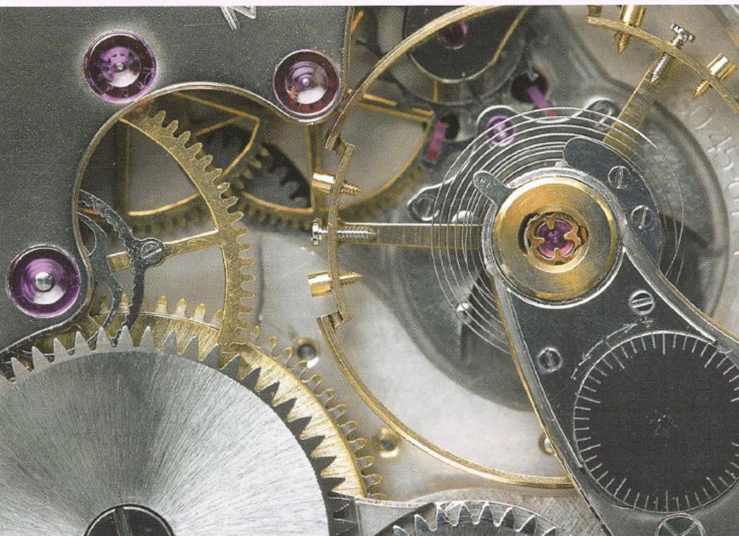
Die Feineinstellung am Rückerkranz wird über eine kleine Kreuzschlitzschraube (am unteren Bildrand gerade noch sichtbar) vorgenommen. Der große runde Deckel trägt eine Skala.
