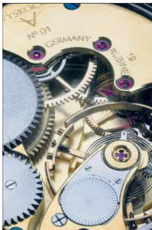
Neue Proportionen von Zahnrädern und Federhaus.
